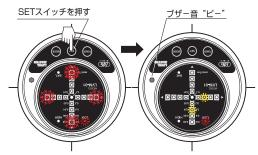
③10秒後、再度『SET』スイッチを押す とブザー音が"ピー"と鳴り『ゼロ調整』 が完了です。
