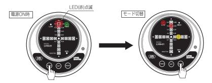
⑤ LOW モードでセンター位置のLED(青)が点灯するようにレベル調整を行ってください。LED(青)が点灯時は、傾きは0.1以下です。
